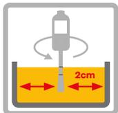
3 Sensor bis zum markierten Bereich in das Frittier-Öl eintauchen. Leicht rühren, bis die Temperaturanzeige +/- 5 °C von der tatsächlichen Öl-Temperatur abweicht. (Mindestabstand zwischen Sensor und Fritteuse: 2 cm)
