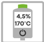
4 Messgerät ruhig halten bis der Messwert stabil ist und der %TPM Wert permanent angezeigt wird (Lampe blinkt grün, gelb oder rot).
